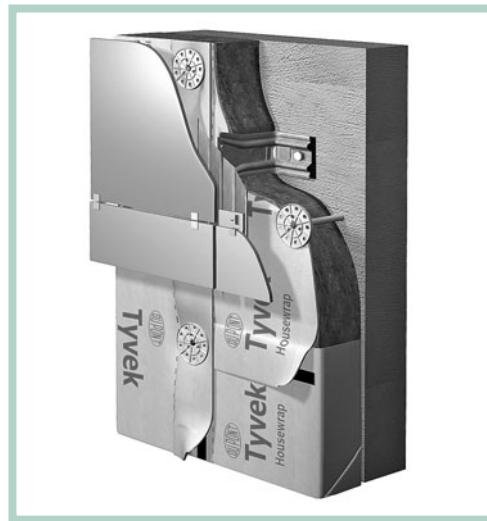
Пригодным продуктом является DuPont™ Tyvek®. Фасад – ветрозащитная и сверхпаропропускаемая мембрана. Мембрана укладывается прямо на поверхность теплоизоляционного материала, закрепляется тарельчатыми шпонками. В местах прохода анкеров и тарельчатых шпон мембраной и нахлесткой мембранны соединяются системной лентой Tyvek®.
